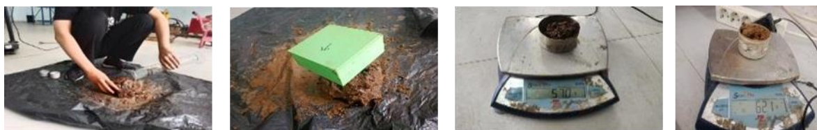
Gambar 5 (a) Proses penambahan air (b) pengukuran kelembaban tanah (c) pengukuran berat tanah W_b (kelembaban tanah sebelum di oven) (d) pengukuran berat tanah kering W_k setelah di oven
