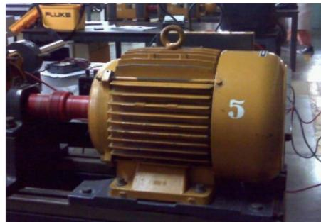
Gambar 1. Motor induksi 3-fasa rotor sangkar sebagai objek penelitian
