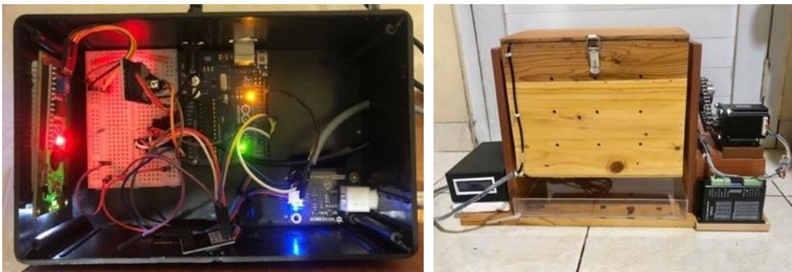
**Gambar 3. Realisasi sistem keseluruhan berupa elektrikal (kiri) dan mekanik (kanan)**
