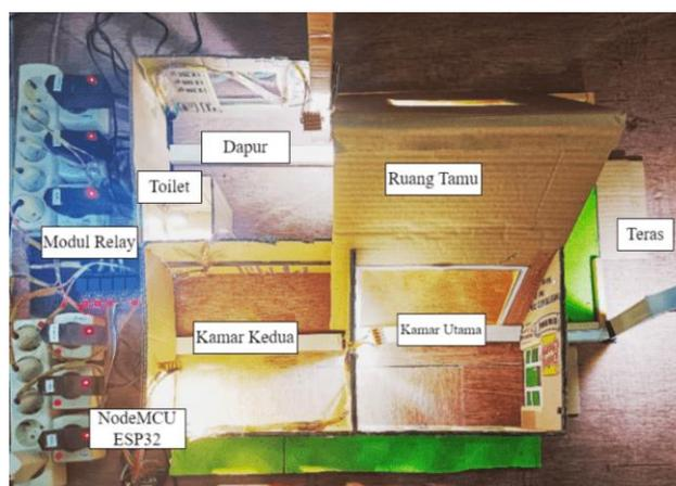
**Gambar 6. Implementasi perangkat keras pada sistem kendali lampu**
